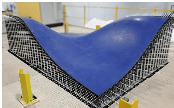
Figure 1. Exemple d'un moule adaptatif. Photo tirée de <https://www.bespline.ca/>
